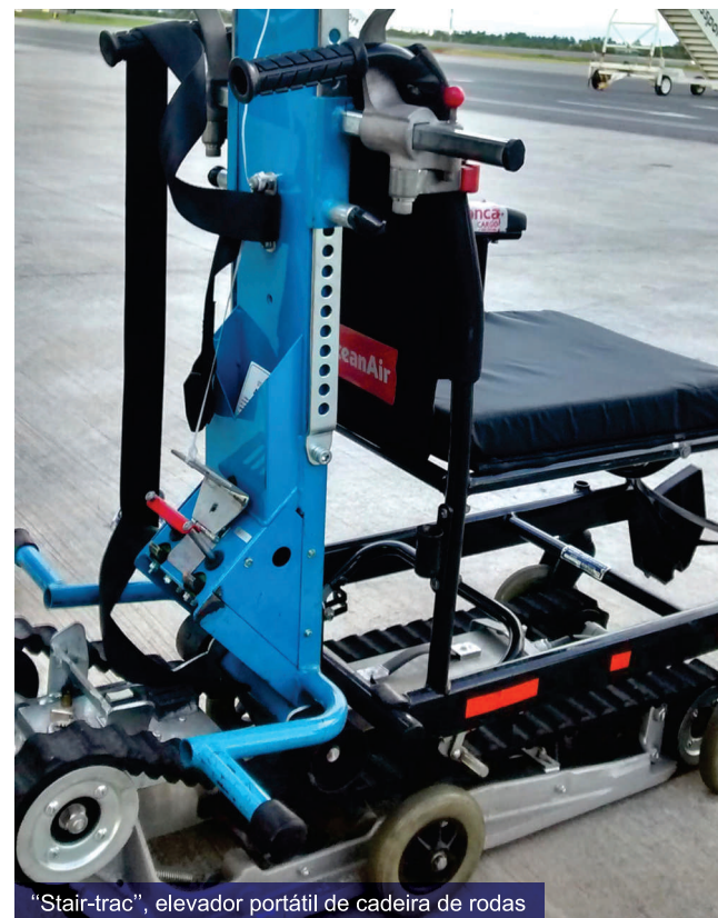
“Stair-trac”, elevador portátil de cadeira de rodas
